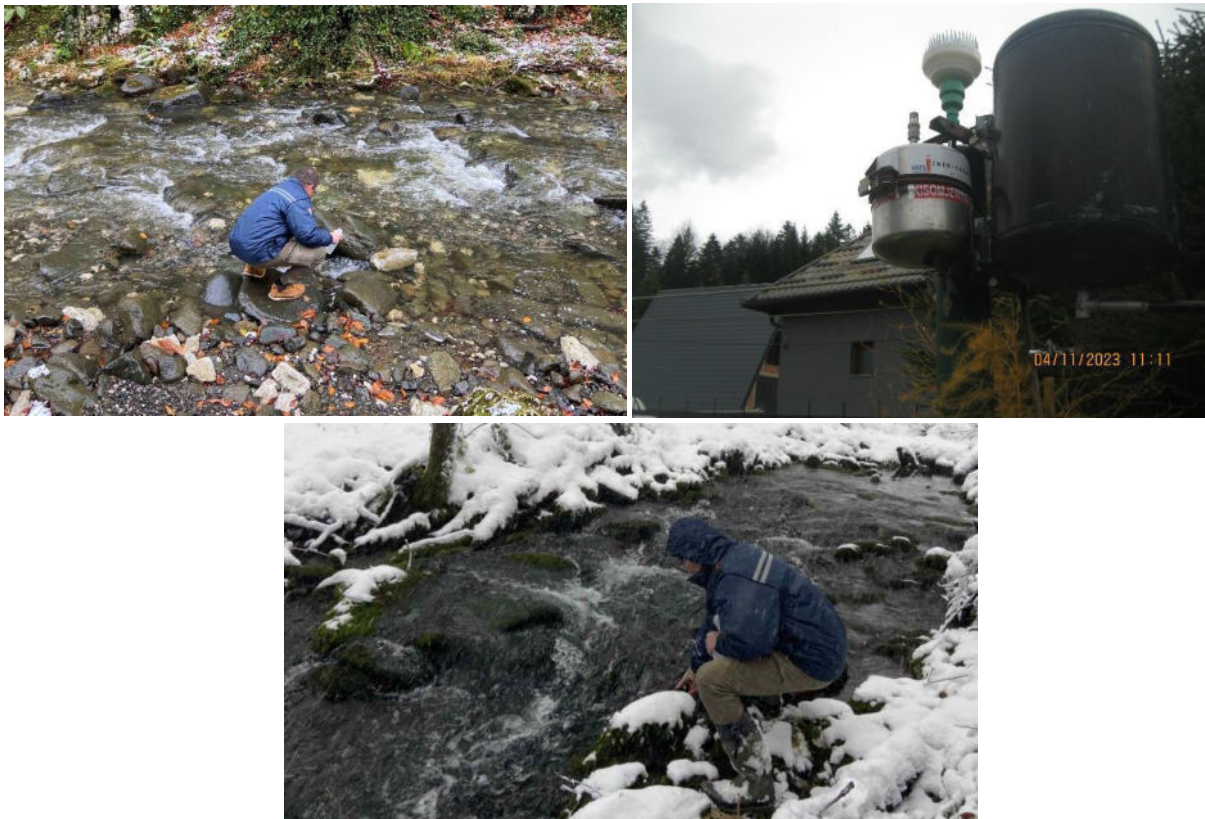
Slika 20. Uzorkovanje površinskih voda rijeke Suhe (gore lijevo), privremeni kišomjer na lokalitetu Ponijeri (gore desno) i uzorkovanje podzemnih voda na izvoru Žučice (dole)
